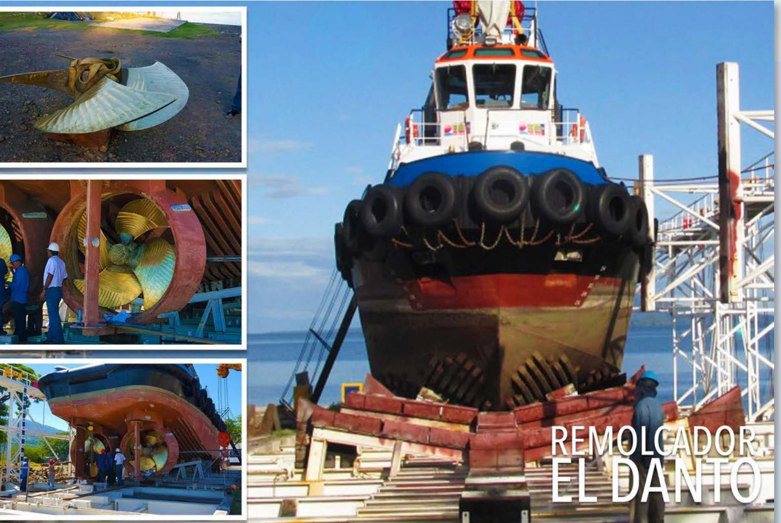
Propiedad de la Empresa Portuaria Nacional (EPN) de Nicaragua, al que se le brindó reparación de propelas y ejes de propulsión, cambio de cojinetes, lavado a presión de casco y aplicación de pintura.
