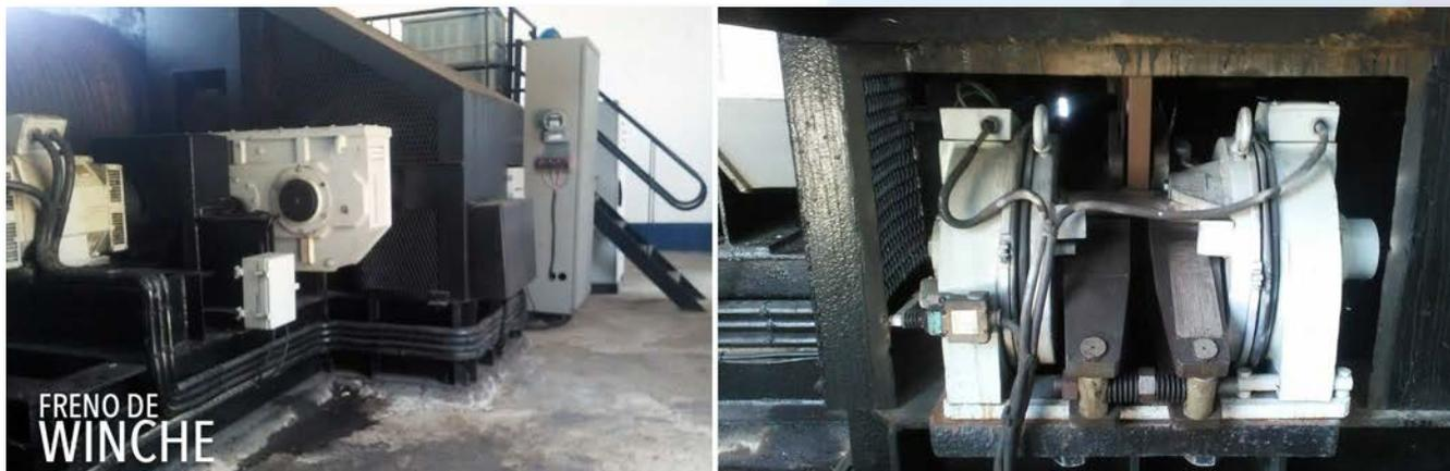
Suministro de un nuevo arrancador electrónico de estado sólido para tener un control más preciso del movimiento del carro durante las operaciones de varada y botadura de los buques. Además se realizó reparación del sistema de frenado el cual se encontraba fuera de operación.
