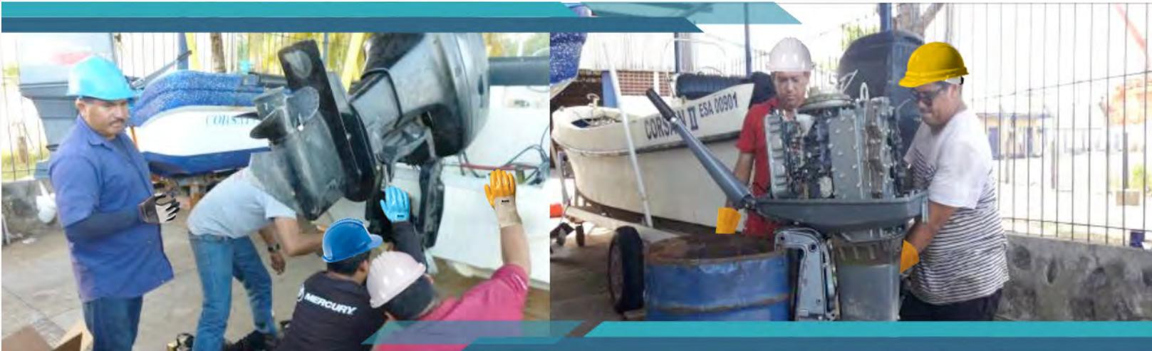
Se realizó el mantenimiento y reparación del motor marino fuera de borda a la lancha CORSAIN I y suministro e instalación de winche eléctrico para el sistema de izaje de lancha CORSAIN II, con el fin de mantener en óptimas condiciones los equipos de apoyo para las maniobras que se realizan en las operaciones portuarias.
