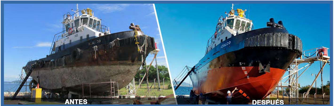
En noviembre de 2016, el remolcador Izalco ingresó para reparaciones a Puerto CORSAIN, Propiedad de la Comisión Ejecutiva Portuaria Autónoma (CEPA), al cual se le realizaron servicios de mantenimiento a la estructura del casco y cubierta, trabajos de cambios de láminas, reparación del sistema de propulsión, limpieza de tanques y sentinas, cambio de defensas, entre otros.
