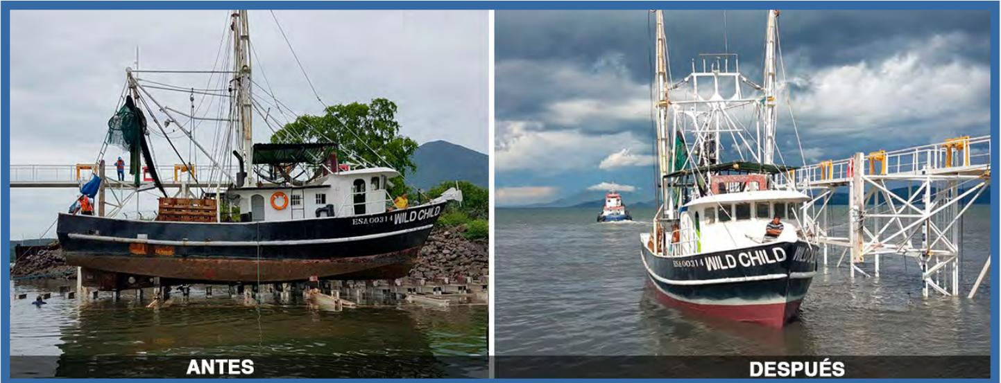
El 14 de junio de 2017, se realiza la maniobra de varada del Wild Child, al cual se le realizaron trabajos de reparación en aplicación de pintura en obra viva y desmontaje e instalación de ánodos de zinc.
