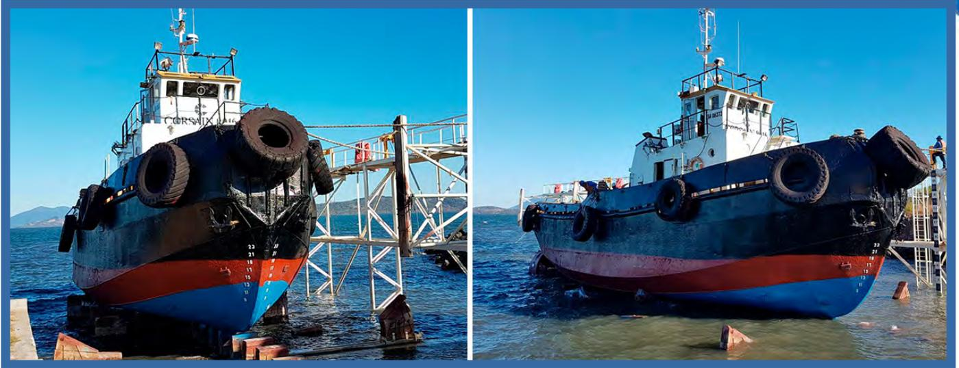
El 14 de Diciembre de 2017, se realiza la maniobra de varada, remolcador propiedad de la Corporación Salvadoreña de Inversiones, y que es utilizado para la prestación de servicios portuarios en la ejecución de maniobras de atraque y desatraque de buques en muelle. Se realizó inspección de lámina a casco en obra viva y muerta, cambio de válvulas de tomas de agua de mar, limpieza de tuberías y rejillas, entre otros.
