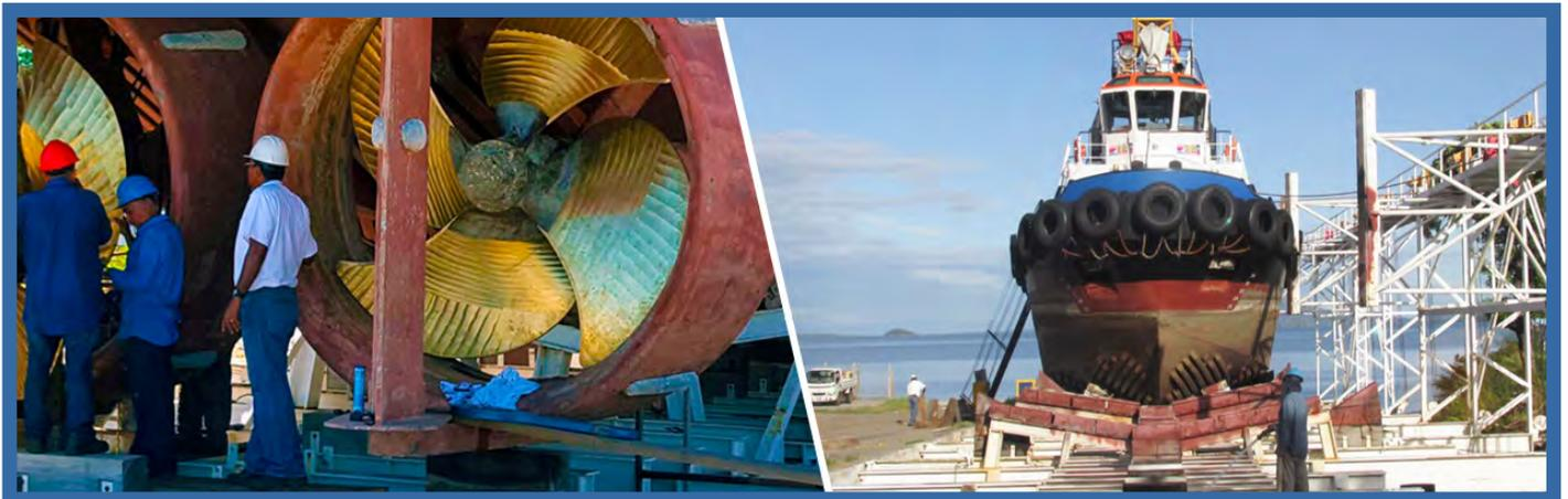
En Noviembre de 2015 arriba a Puerto CORSAIN para reparación, el remolcador El Danto, propiedad de la Empresa Portuaria Nacional (EPN) de Nicaragua, al que se le brindó reparación de propelas y ejes de propulsión, cambio de cojinetes, lavado a presión de casco y aplicación de pintura.
