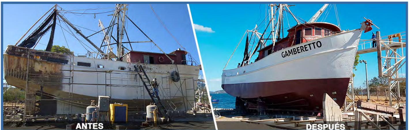
El 27 de enero de 2017, ingresó a varadero el barco camaronero Gamberetto, entre los trabajos realizados se pueden mencionar: reparación en el sistema de propulsión, arenado y aplicación de pintura en obra viva.
