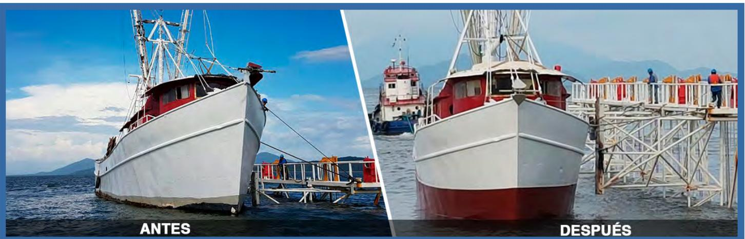
El 27 de mayo de 2017, arriba a Puerto CORSAIN el barco camaronero San Miguel I, al que se le realizaron los trabajos de aplicación de pintura en obra viva y desmontaje e instalación de ánodos de zinc.
