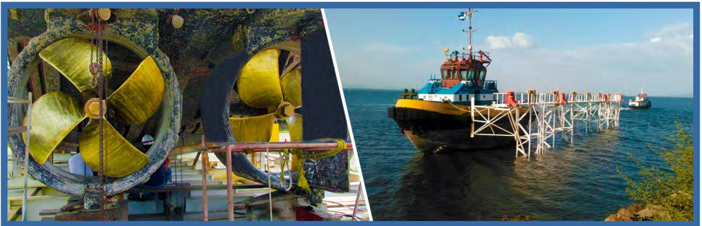
En junio de 2016, el remolcador El Poseidón, propiedad del Régimen de Pensiones y Jubilación del Personal de la Empresa Portuaria Quetzal de Guatemala, ingresa para que se le brinden servicios de reparación de sistema de propulsión, entre otros: desmontaje de sistema, cambio de cojinetes, rectificado de ejes, propelas.
