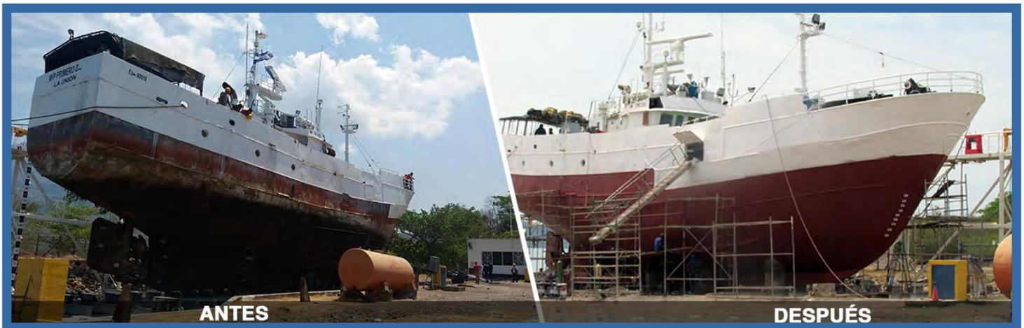
En Abril de 2017, arriba el barco pesquero Primero Dios, para reparación. Entre los trabajos realizados se pueden mencionar: lavado al casco a alta presión en obra viva y muerta, rasqueteo en obra viva, arenado comercial al casco SA-2, aplicación de pintura en obra viva y remoción e instalación de ánodos de zinc.
