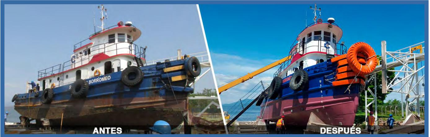
El 6 de mayo de 2016, se realizó maniobra de varada del remolcador San Carlos Borromeo, propiedad de CORSAIN, el que se utiliza para la prestación de servicios portuarios en la ejecución de maniobras de atraque y desatraque de buques en muelle. Se reparó el sistema de propulsión y de casco, culata de motor de estribor, inyectores y cambio de válvulas. Asimismo, se realizó pintura en cubierta.
