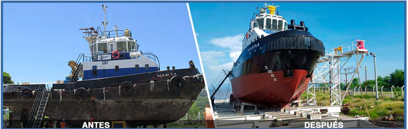
El 4 de septiembre de 2015, atracó el primer remolcador propiedad de la Comisión Ejecutiva Portuaria Autónoma (CEPA), al cual se le realizaron servicios de reparación del sistema de propulsión y de casco, aplicación de pintura, cambio de tuberías y válvulas internas del barco.
