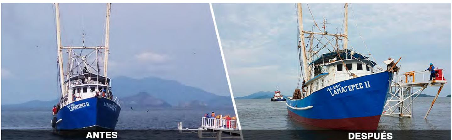
El Lamatepec II, es propiedad de la empresa ESCAMA, S.A. de C.V. al que se le realizaron servicios de reparación de aplicación de pintura en obra viva y cambio de lámina.
