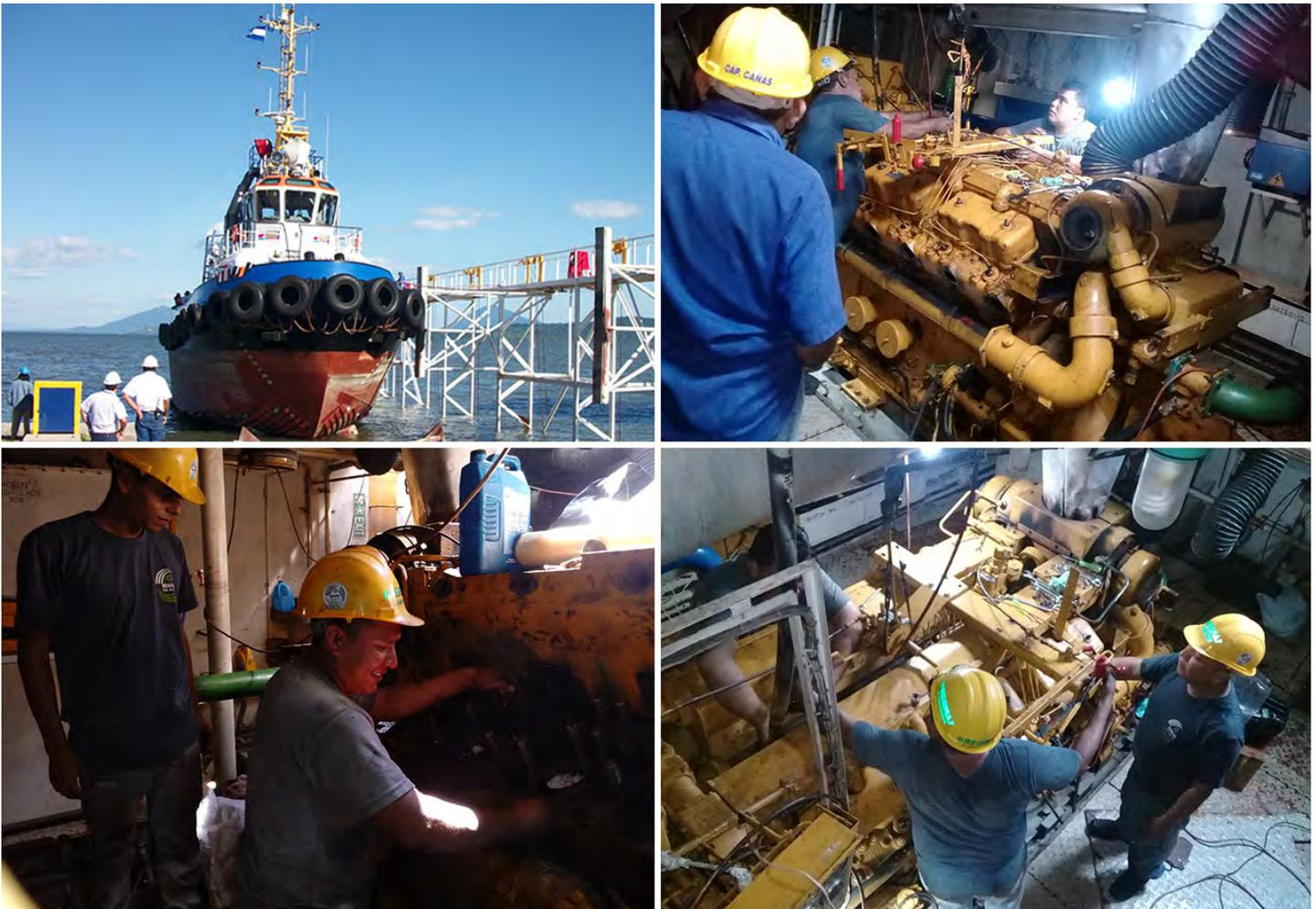
Como parte de las actividades de mantenimiento de equipos auxiliares para las operaciones portuarias, se realizó el mantenimiento correctivo de generador de estribor de Remolcador San Carlos Borromeo, trabajos que fueron realizados en el período del 8 al 27 de agosto de 2018.
